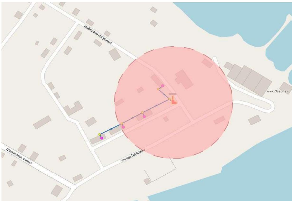
Рис. 7.15.1 – Радиус эффективного теплоснабжения котельной п. Озерпах
