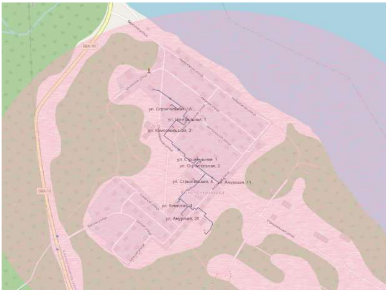
Рис. 2.5.1 – Радиус эффективного теплоснабжения котельной №1, R=811\text{м}
