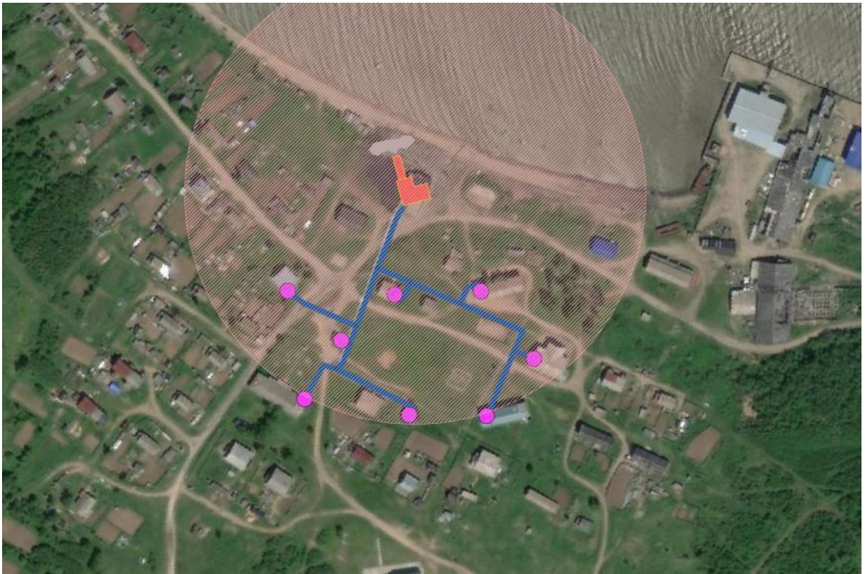
Рис. 7.15.1 – Радиус эффективного теплоснабжения котельной №1, R=175\text{м}
