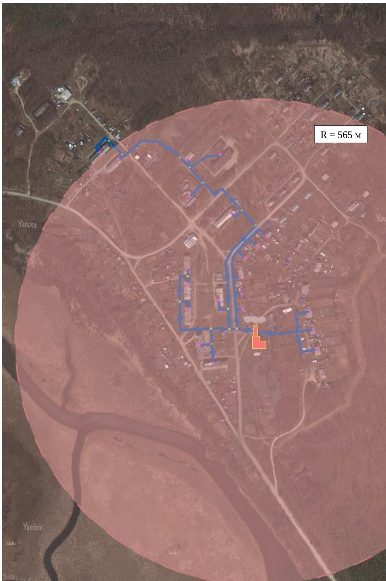
Рис. 7.15.1 - Радиус эффективного теплоснабжения котельной №1
