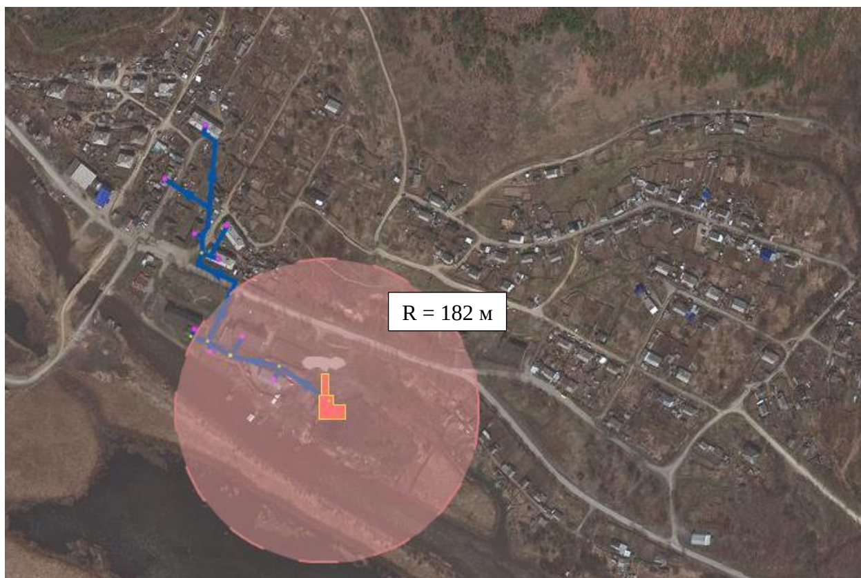
Рис. 7.15.2 - Радиус эффективного теплоснабжения котельной №2
