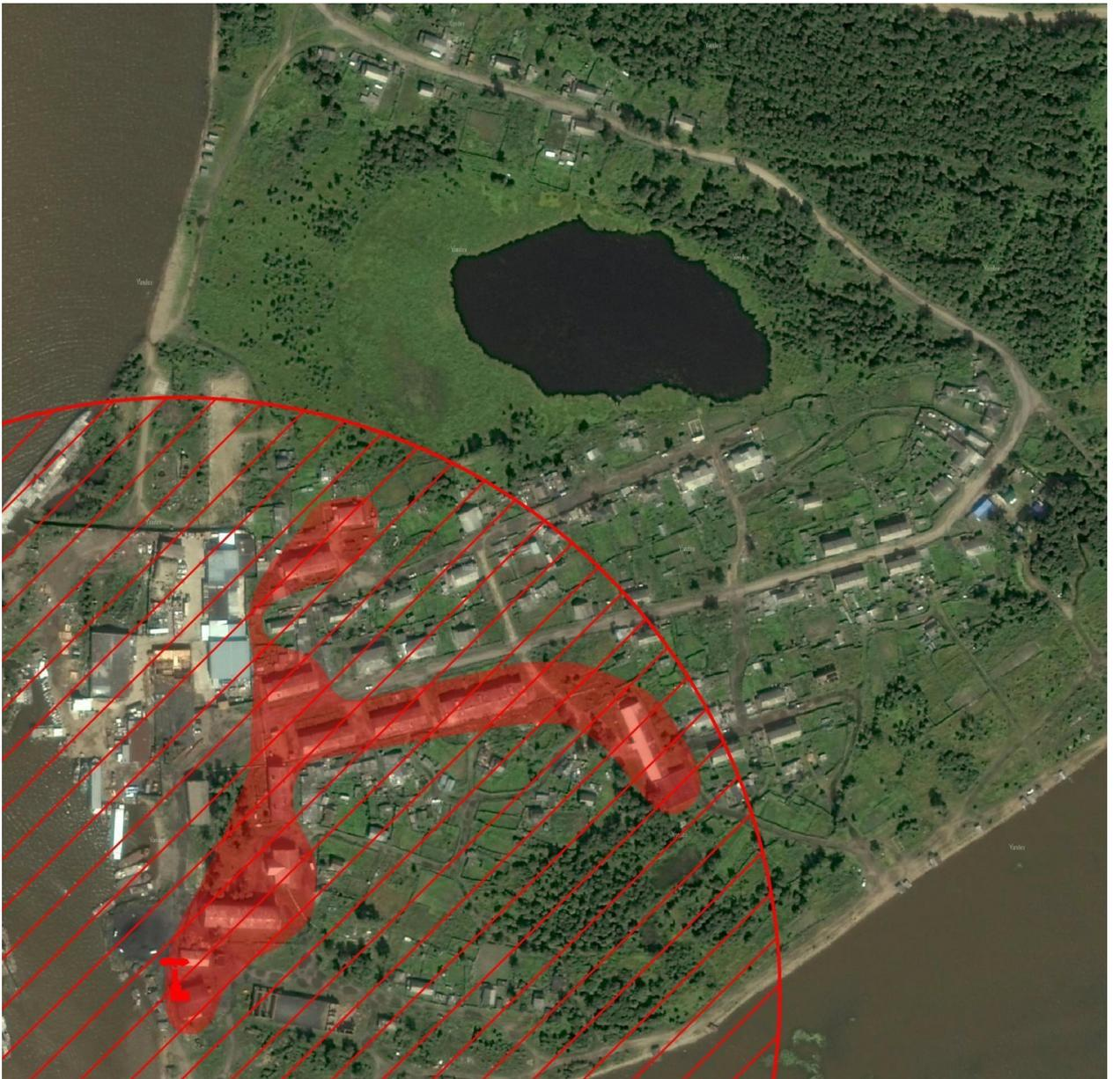
Рис. 7.15.3 – Радиус эффективного теплоснабжения котельной №3
