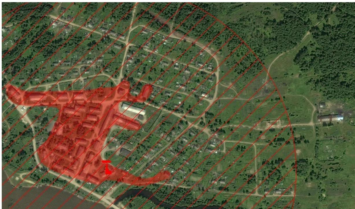
Рис. 7.15.2 – Радиус эффективного теплоснабжения котельной №2
