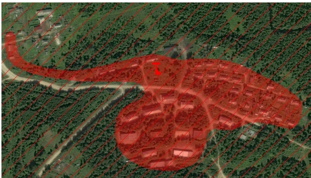
Рис. 7.15.1 – Радиус эффективного теплоснабжения котельной №1
